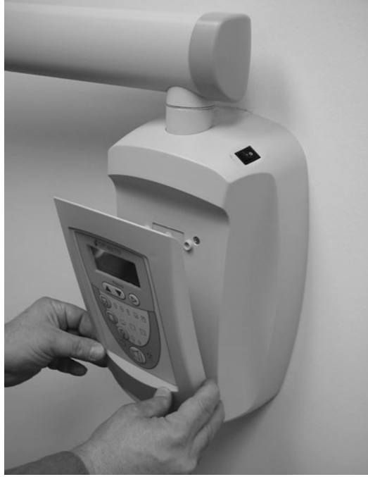
صورة 37 التثبيت في لوحة التشغيل
